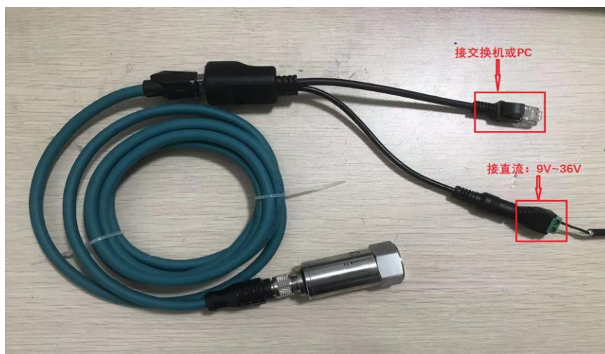
图 3 网线供电合路器连接示意图
