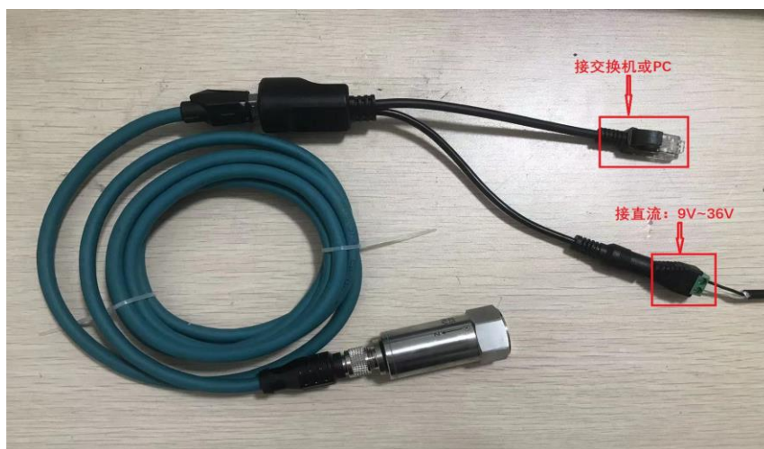
图 3 网线供电合路器连接示意图
