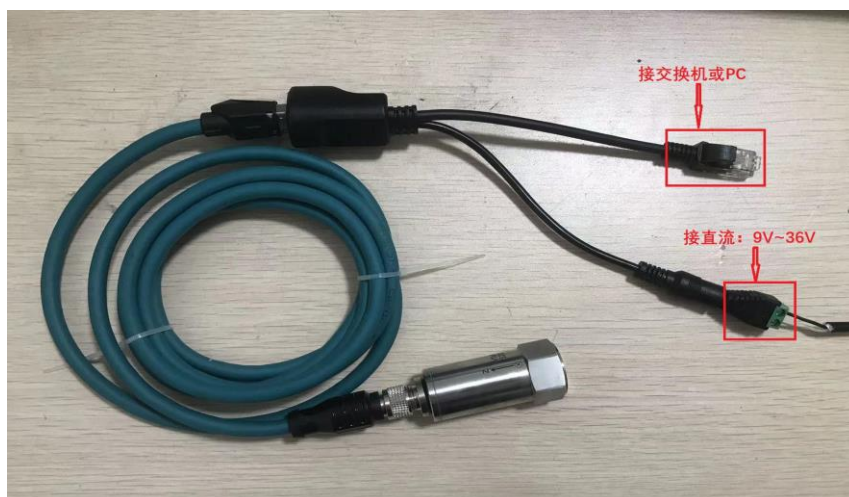
图 3 网线供电合路器连接示意图
