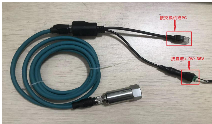
图 4 网线供电合路器连接示意图
