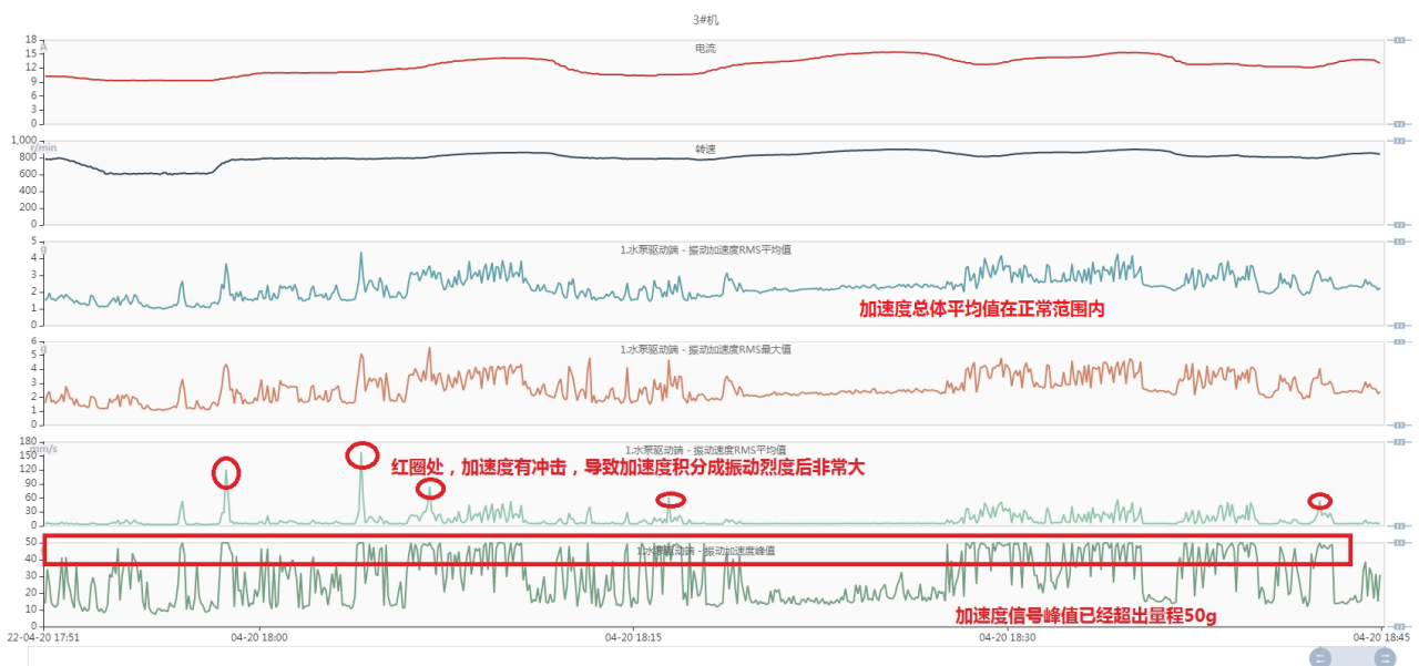
图（2） - 3#泵组振动稳态数据异常处标注与说明
