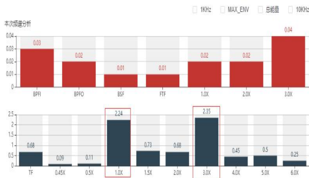
图 2、水泵驱动端(V)温度、振动频谱特征与趋势
