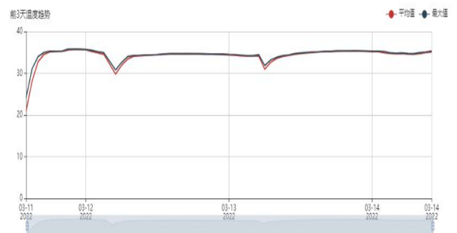
图 2、水泵驱动端(V)温度、振动频谱特征与趋势
