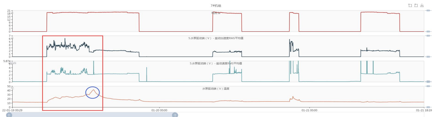
图 2、水泵驱动端测点振动、温度趋势图
