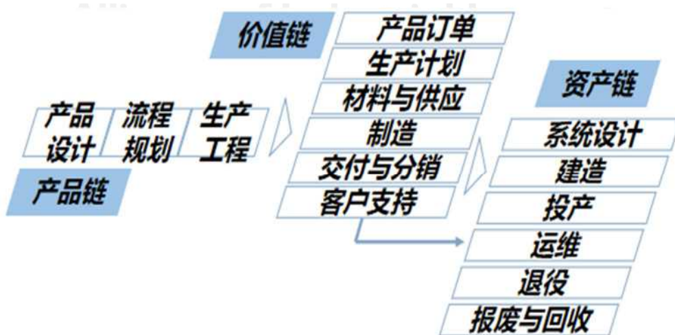
图 6 工业互联网业务视图应用层架构
