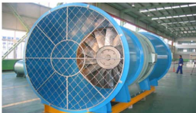
地铁站轴流风机系统
